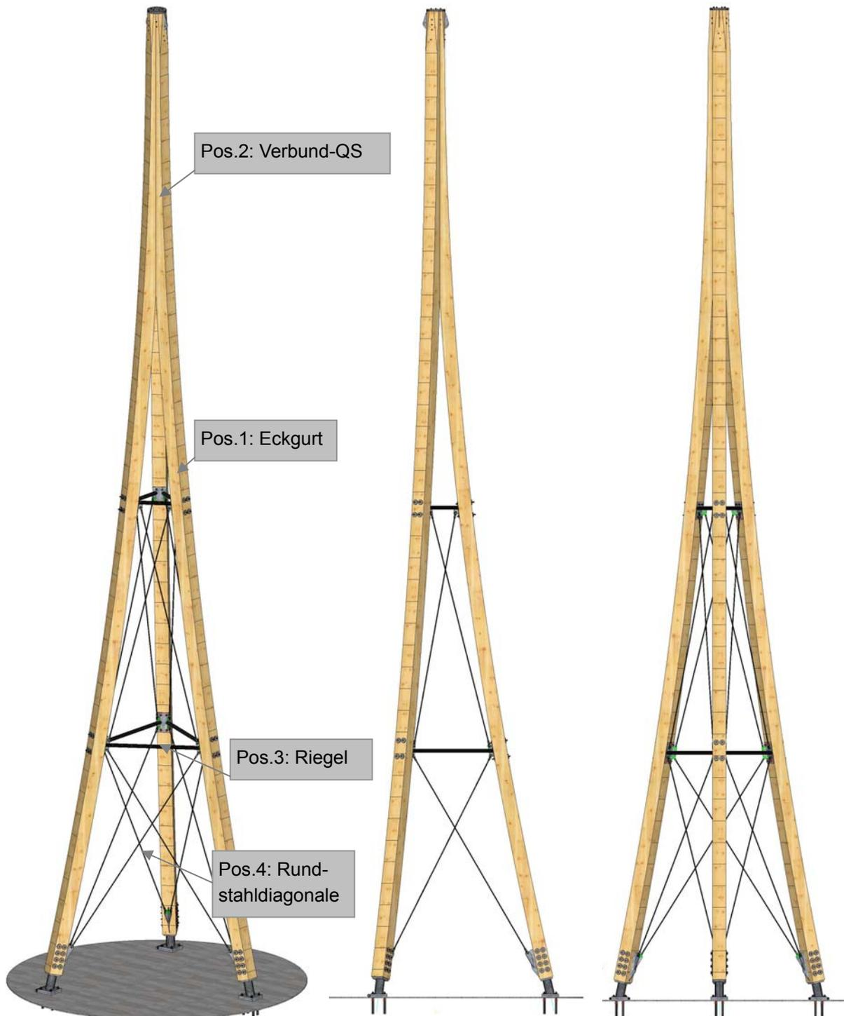
**Abbildung 6-15: Positionsübersicht und verschiedene Ansichten der Turmkonstruktion**
