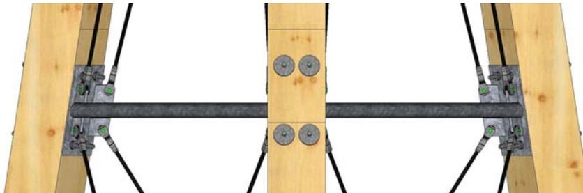
**Abbildung 6-18: Unterer Druckriegel- und Zugstabanschluss**
