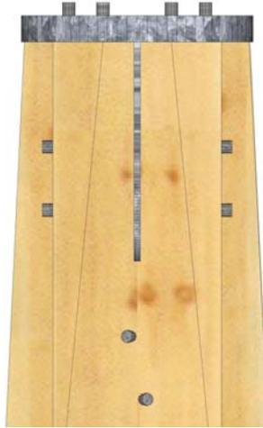
**Abbildung 6-16: Turmkopf mit Schlitzblech für Montageeseil und Aufnahmeplatte für Gondelflansch**
