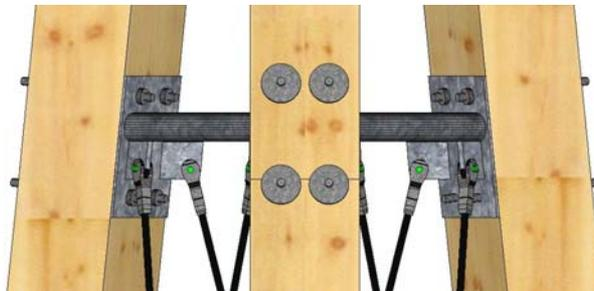
**Abbildung 6-17: Oberer Druckriegel und Zugstabanschluss**
